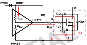
FIGURE 18. TYPICAL UPPER-GATE DRIVE TURN-ON PATH
